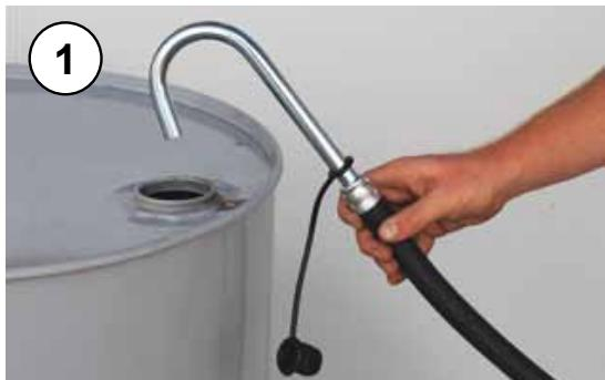
Inserire il tubo di scarico nel contenitore di raccolta olio esausto.
