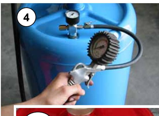
Collegare la pistola gonfiagomme al raccordo e pressurizzare il serbatoio. La valvola di sicurezza si aprirà alla pressione di 0,5 bar.
