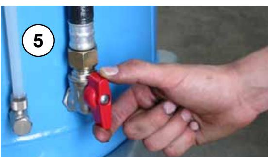
Aprire la valvola in modo da scaricare l' olio. Controllare il livello e pressurizzare il serbatoio quando necessario.
